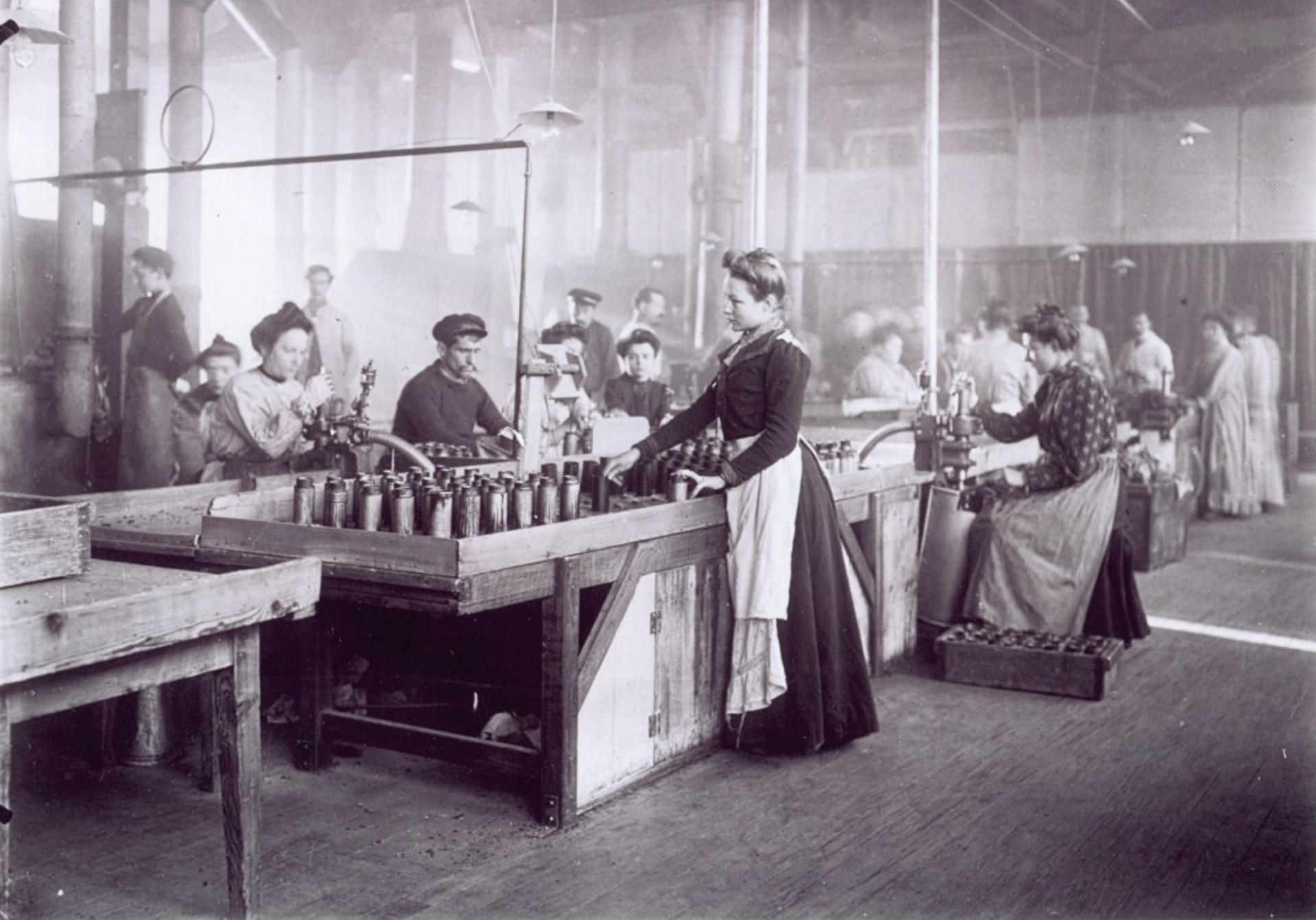
Remplissage des moules de cylindres (usine de Chatou, 1905)
